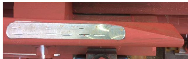
Figuur 12 Gefreesd materiaalmarkering TTG puntstuk (gewijzigde bouwvorm, gewijzigde profilering)
